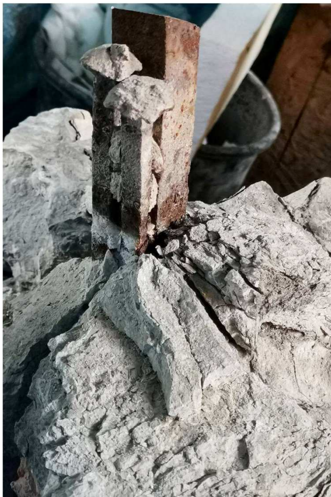
Fot. nr 23. Korodujący trząpień montażowy z dodatkowymi gwoździami powodujące rozsadzanie podstawy figury.
